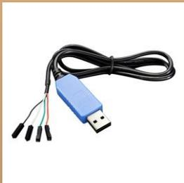
Conclusión. No es un puerto USB. Es un puerto serial. Y, midiendo con el tés-ter, pude determinar cual de los cables del conector corresponde al TX y cual al RX del puerto serial. Corté un cable USB mini y lo "empalmé" con uno serial TTL a USB de los que se usan para hobbies, robótica, proyectos de arduino, etc.; también lo tenía en el cajón.
